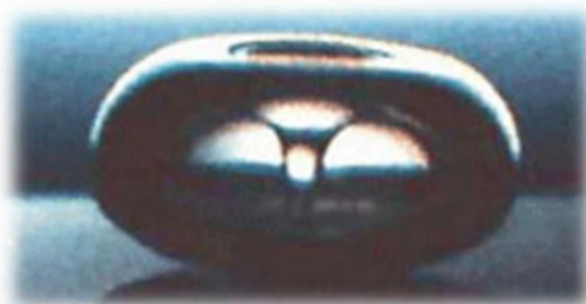
Рисунок 1 – Кавитационный пузырек в момент взрыва [1] ←
